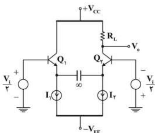
۶۷- در تقویت‌گننده تفاضلی روبه‌رو،  $Q_1$  و  $Q_2$  کاملاً مشابه هستند و به ازای  $I_1 = I_2 = 1\text{mA}$  بهره ولتاژ سیگنال کوچک  $\frac{V_o}{V_i} = 60$  است. اگر فقط مقدار جریان منبع  $I_2$  افزایش یافته و  $I_2 = 2\text{mA}$  شود، بهره ولتاژ به چه مقداری خواهد رسید؟
