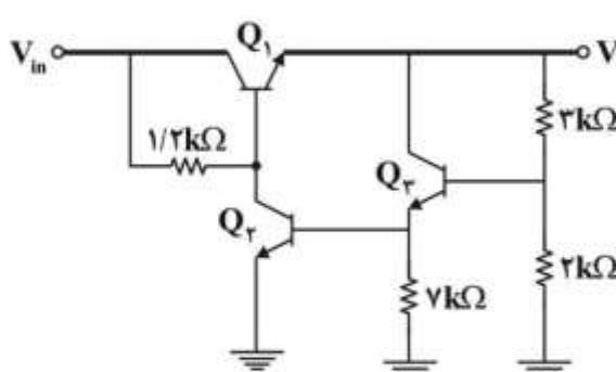
۶۹- در رگولاتور ولتاژ روبه‌رو، ولتاژ ورودی بین ۹ تا ۱۵ ولت متغیر است. اگر  $\beta = 100$  و  $V_{BE(on)} = 0.7\text{V}$  باشد، حداکثر جریان قابل قبول برای بار ( $I_{L,max}$ ) چند آمپر است؟
