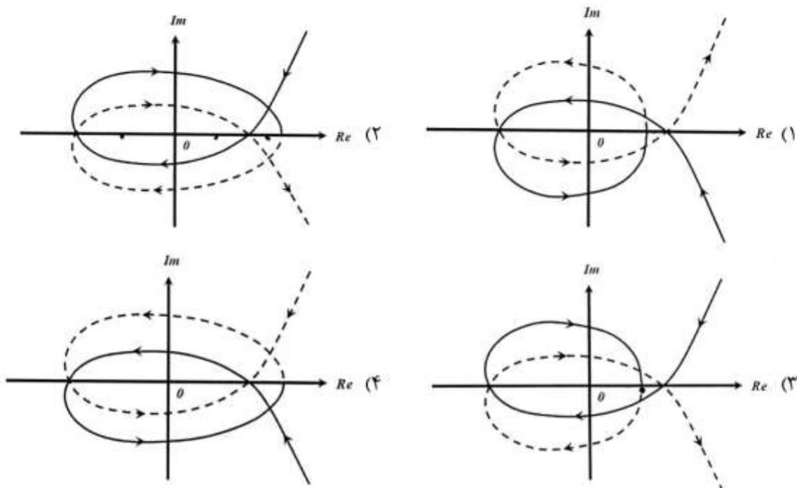
۱۰۱- در سیستم فیدبک واحد زیر با دیاگرام قطبی داده شده، چه کنترل کننده‌ای برای خطای ماندگار صفر به ورودی پله واحد مناسب است؟ ( $G(s)$  پایدار است)
