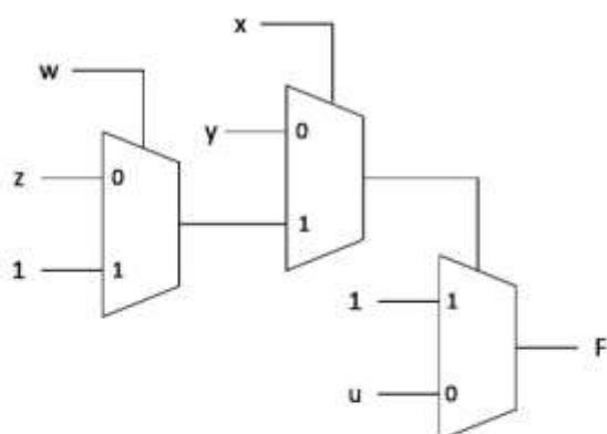
$$WZ + XY + U\bar{X}\bar{W} + U\bar{W}\bar{Y} + U\bar{X}\bar{Z} + U\bar{Y}\bar{Z} \quad (1)$$
