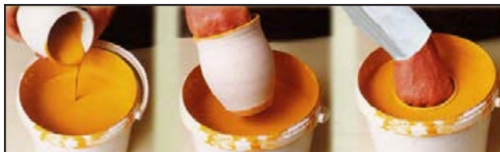
شکل ۱۹- لعاب‌زنی دستی و کارگاهی
