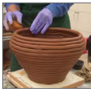
شکل ۹- بدنه‌های مختلف شکل‌دهی شده با روش فتیله‌ای
