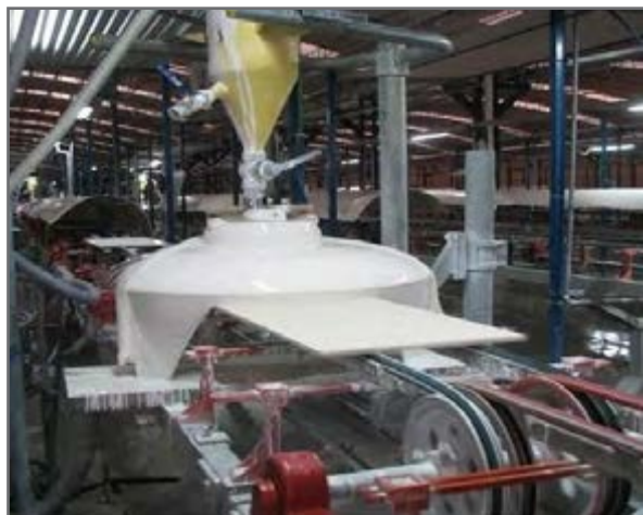
شکل ۲۳- لعاب‌زنی به روش آبشاری
