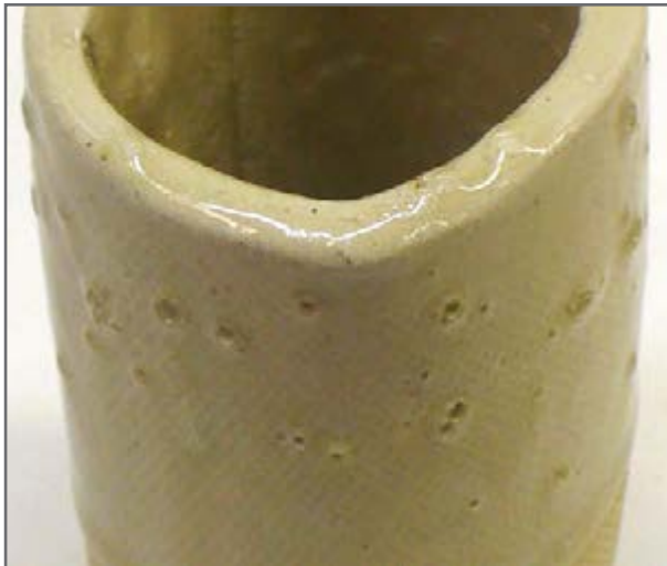
شکل ۳۴- عیب تاول زدن لعاب
