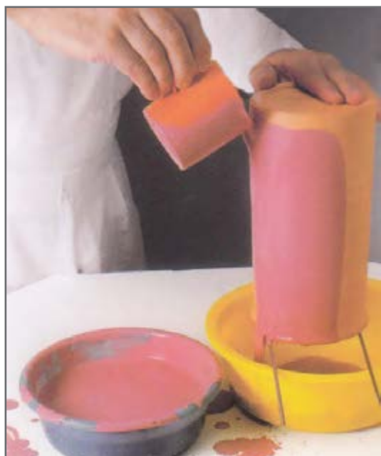
شکل ۱۴- اعمال لعاب به روش ریختنی
