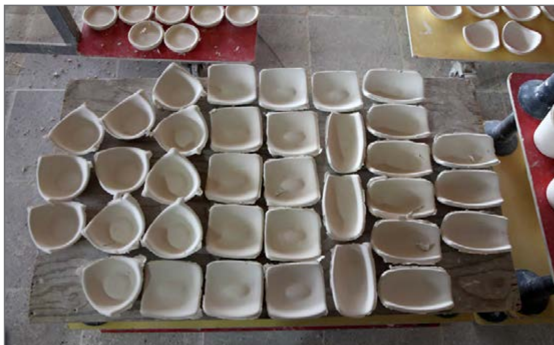
شکل ۱۰- ناهمواری و زوائد روی سطح قطعات مختلف سرامیکی
