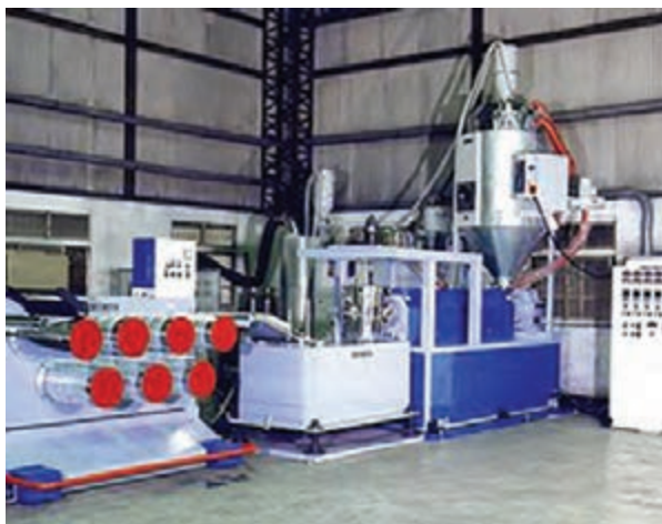
شکل ۱ - دستگاه تولید الیاف پلی‌استر
