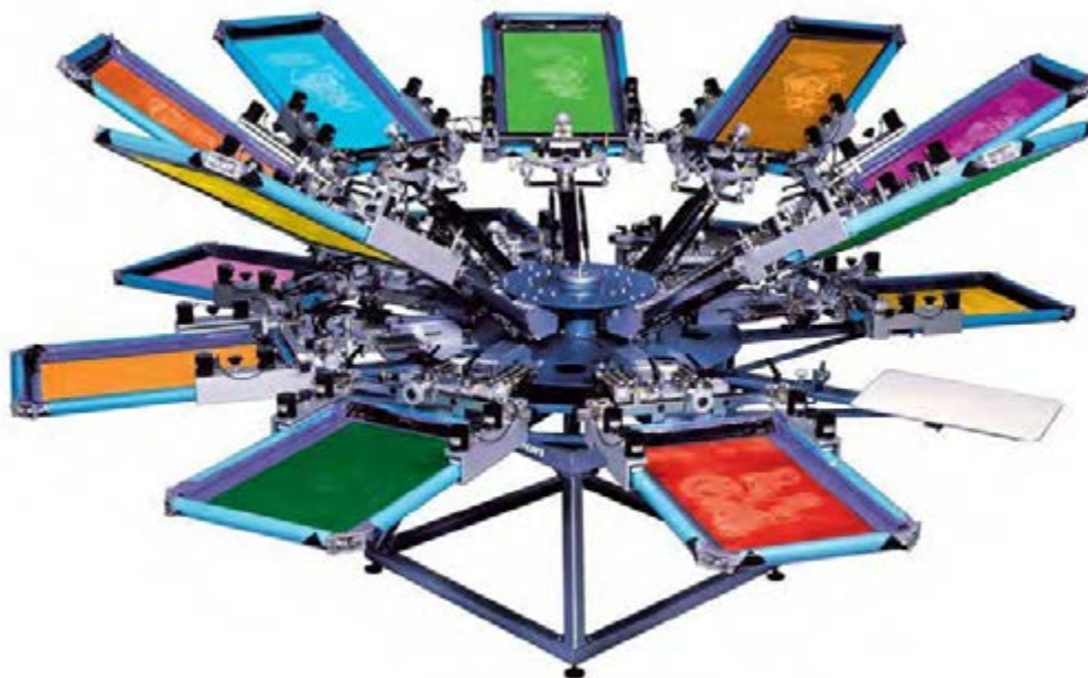
شکل ( ۳۰ - ۴ ) گیره های شابلون در ماشین چاپ اسکرین چند رنگ
