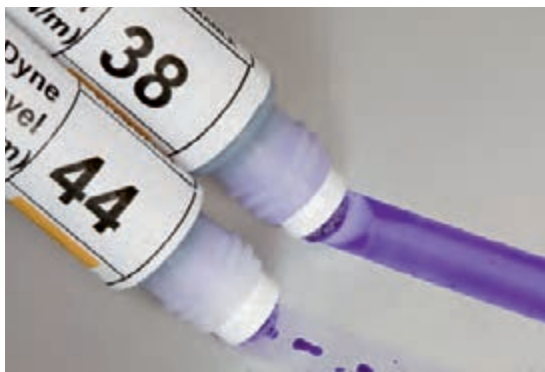
شکل ۳-۴۳ روش استفاده از ماژیک تستر
