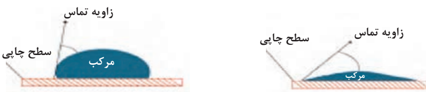
شکل ۳-۴۰ رابطه انرژی سطحی و زاویه تماس
