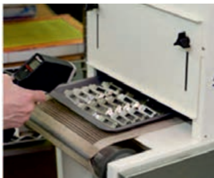
شکل ۶۷-۳ سنجش میزان حرارت خشک کن شکل
