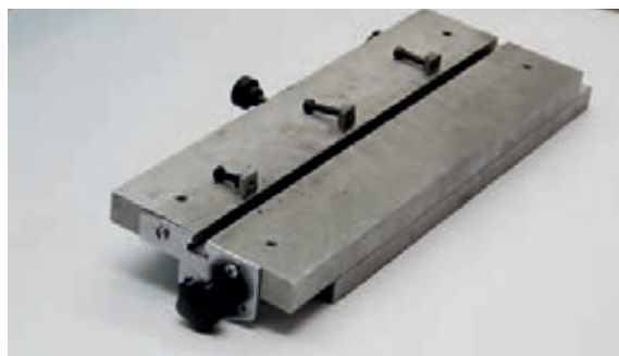
T شکل ۲۶-۵ میز شیاردار- فیکسچر به همراه مهره های
