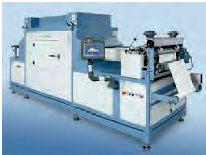
شکل ۳۰-۲ دستگاه حرارت خشک جهت تثبیت بیندرهای مرکب پیگمنت
