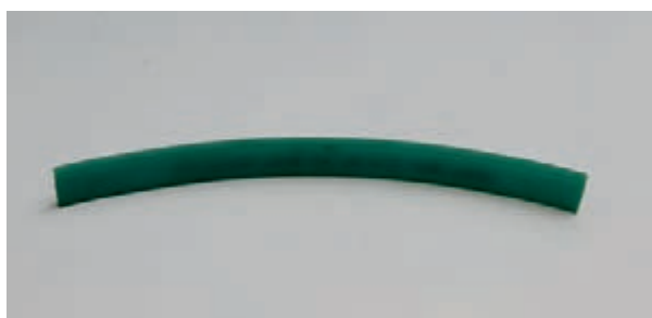
شکل ۵-۳۳ تیغه اسکوئیجی با لبه تیز
