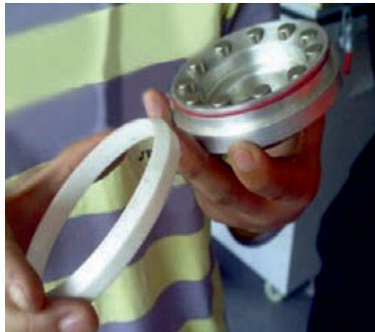
شکل ۴-۵۶ مخزن مرکب آهن ربای پیرامونی
