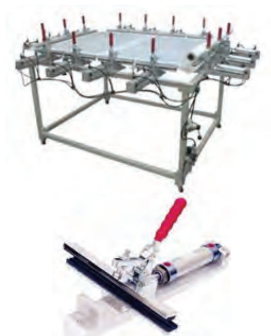
شکل ۲۵-۵- توری کش پنوماتیکی و گیره توری کشی به همراه مانیفولد
