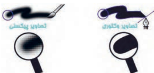
شکل ۲-۵- تفاوت تصویر رستری و وکتوری
