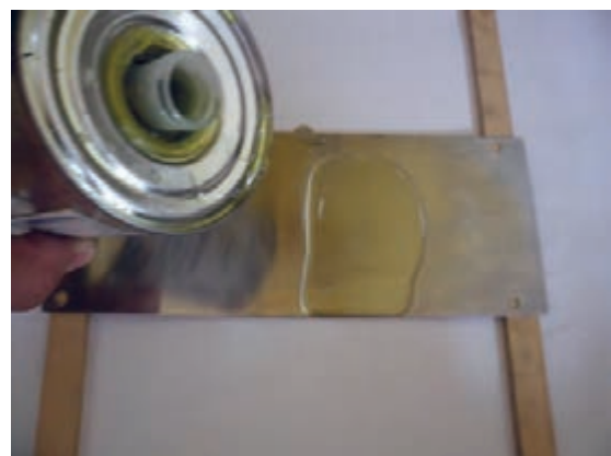
شکل ۴-۱۴- حساس کردن کلیشه خام
