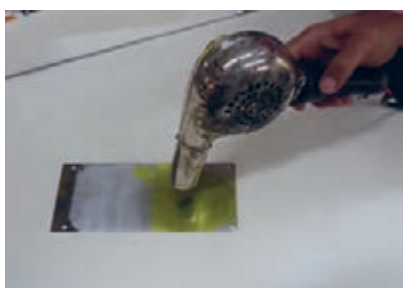
شکل ۴-۲۲- حرارت دادن کلیشه
