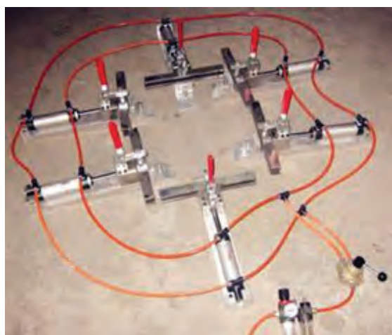
شکل ۲۵-۵- توری کش پنوماتیکی و گیره توری کشی به همراه مانیفولد
