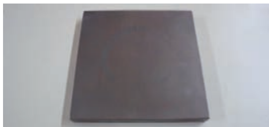
شکل ۴-۵- صفحه خام یا اسید کاری نشده کلیشه
