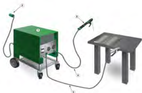
شکل ۴-۴ تجهیزات و دستگاه جوش کاری
