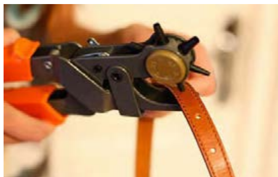
الف) شکل ۳-۱۹ پرچ سوراخ کمر بند
