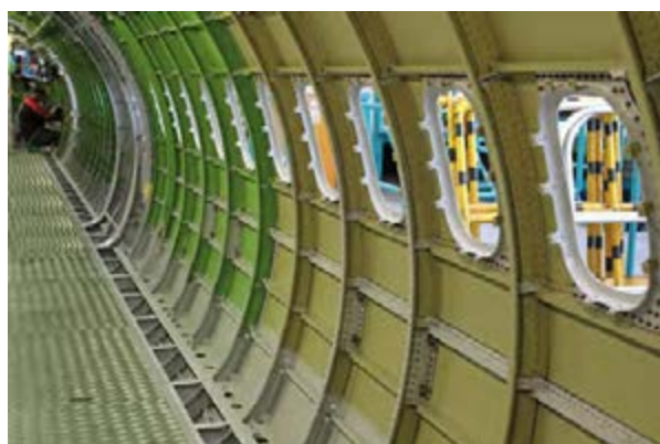
شکل ۳-۱۶ سازه پرچ کاری شده
