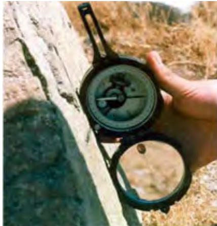
نحوه قرارگیری لبه کمپاس بر روی لایه برای تعیین مقدار شیب
